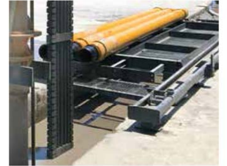
整体运输并带滑轮移动的浆管箱
